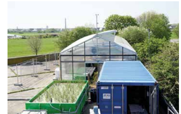
Versuchsanlage mit Filtern, Membrananlagen und Gewächshaus
