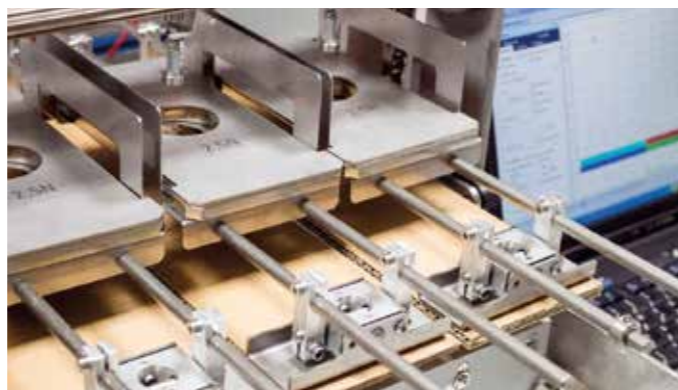
Messung der Tragfähigkeit von Wellpappe unter Biegebelastung (Bildquelle: Papiertechnische Stiftung)
