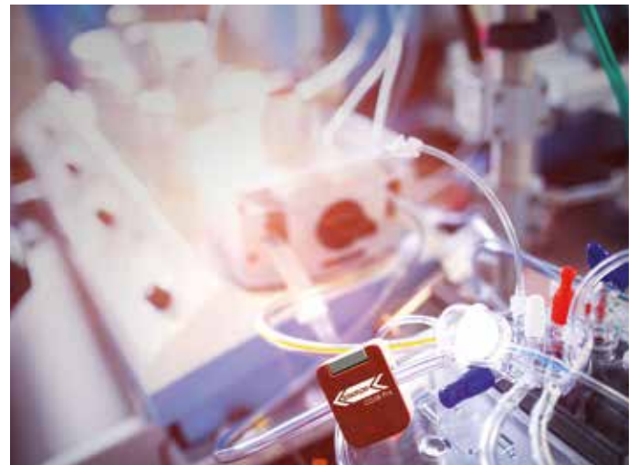
SONOFLOW CO.56 Pro Clamp-On Sensor zur kombinierten Durchflussmessung und Blasenenerkennung an Herz-Lungen-Maschinen (Bildrechte am Composing: SONOTEC GmbH, AdobeStock)
