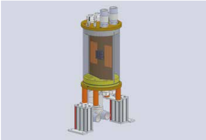
Umweltsimulationseinrichtung mit Prüfkammer und Aufnahmevorrichtung
