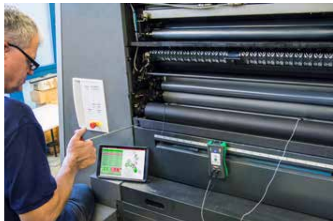
Einfache Einstellung der Kontaktstreifenbreite mit sofortiger Anzeige des aktuellen Werts
