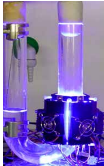
Labora Aufbau zur Entwicklung eines Hygienesiphons mit Blaulichtreinigung
