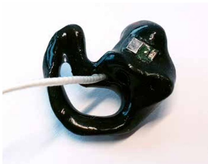
Abb. 1: Der Messkopf wird nach dem Einbringen in die individuelle Otoplastik mit einem biokompatiblen Material vergossen.
