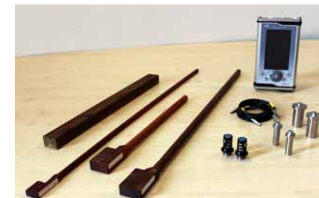
Zu prüfende Objekte aus dem Bereich Musikinstrumentenbau (Beispiele, links) und Hardwarebasis der Lösung (rechts)
