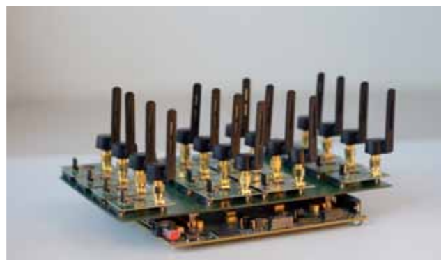
Antennen-Array zur Untersuchung industrieller Datenübertragung per Funk (Foto: ifak)
