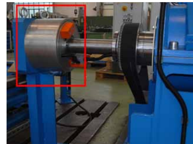
Induktiver Schleifringersatz beim Kunden und Projektpartner SKET Ver-seilmaschinenbau GmbH Magdeburg (Foto: KONTENDA/SKET)
