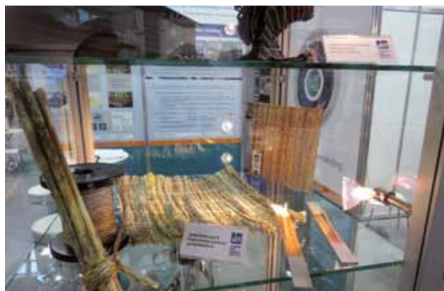
Exponate zur Composites Europe 2017: Textile Halbzeuge für Faserverbunde basierend auf Hanfbastrinde © STFI
